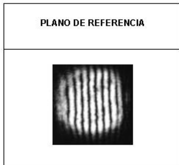
Figura 20 Imagen de referencia del sistema de franjas de el espejo al rotar la primera red un valor de \alpha=11^\circ
