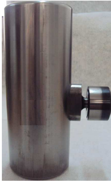
Figura 95. Fotografía modificación camisa soporte seguidor de leva
