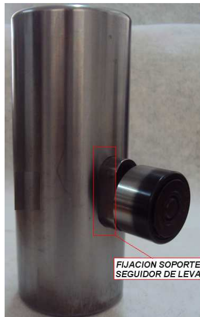
Figura 96. Fotografía detalle fijación soporte seguidor de leva.
