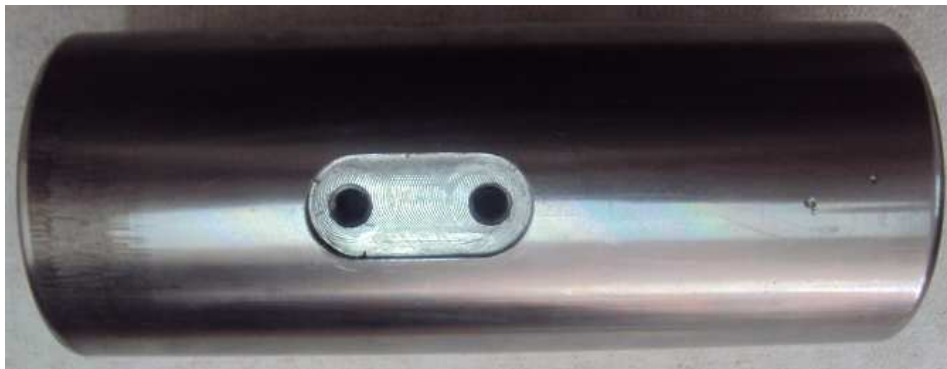
Figura 94. Fotografía modificación camisa soporte seguidor de leva
