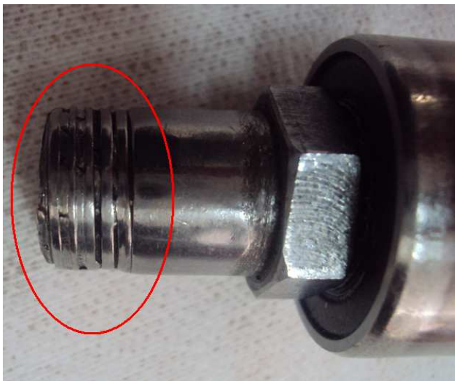
Figura 90. Falla de rosca en Eje soporte de seguidor de leva.
