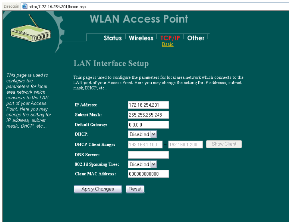
Figura 12. Configuración del Access Point en el punto de Tunja
