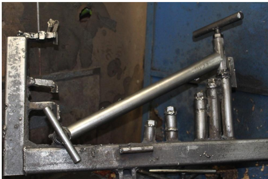
Figura 53. Matriz de soldadura de un marco de bicicleta
