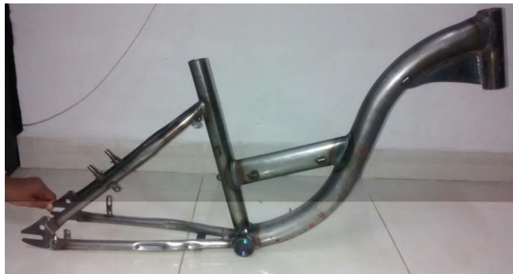
Figura 56. Marco terminado en obra negra
