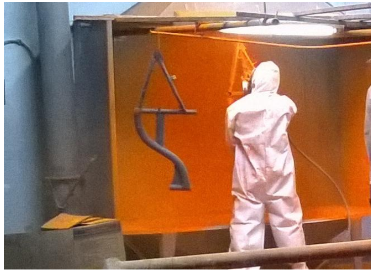
Figura 57. Aplicación de pintura electrostática
