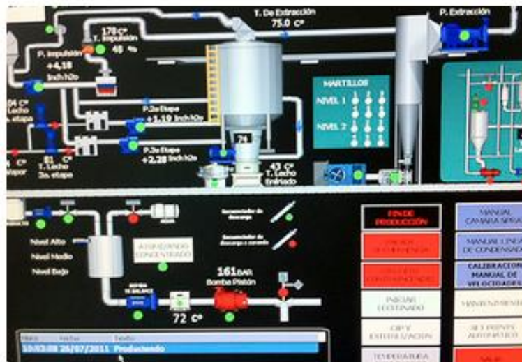
Figura 15 Instrumentación industrial para Caudal, Presión, Nivel y Temperatura.
