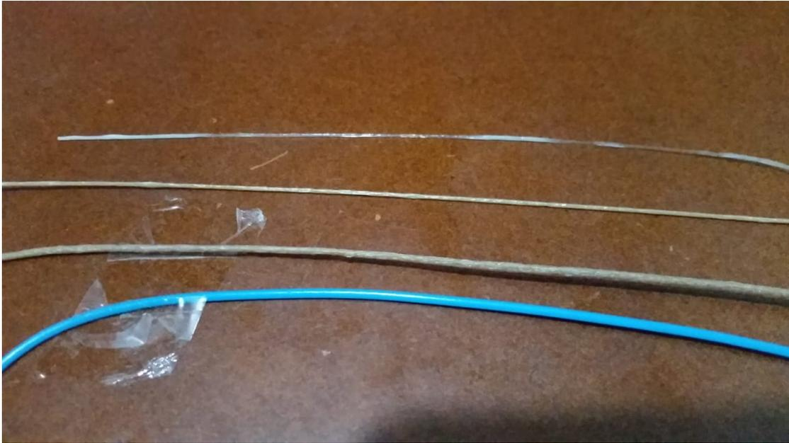
*En esta comparación de algunas muestras del filamento de PET obtenido (gris) y filamento polimérico comercial (azul) se evidencia un diámetro mucho menor, y numerosas imperfecciones que causan un diámetro inconsistente.*
