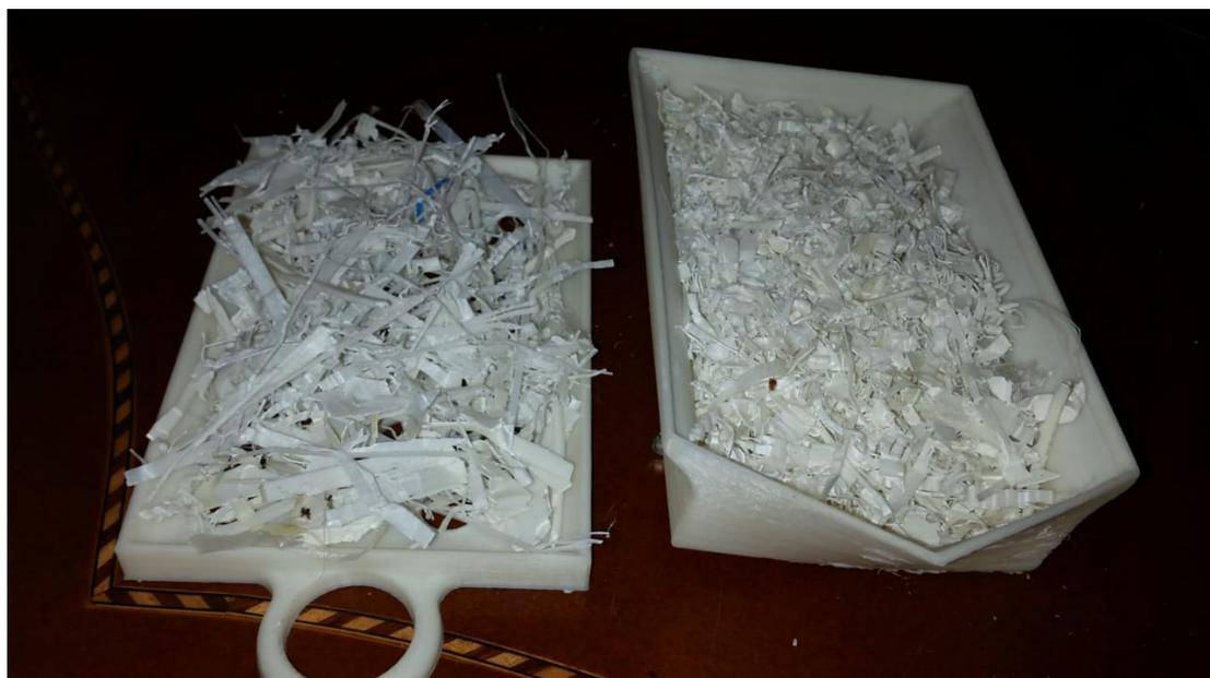
Se realizaron seis pruebas de trituración, cada una con 100 gramos de material, usando tanto botellas de PET como sobrantes de impresiones en ABS, obteniendo los siguientes resultados:
