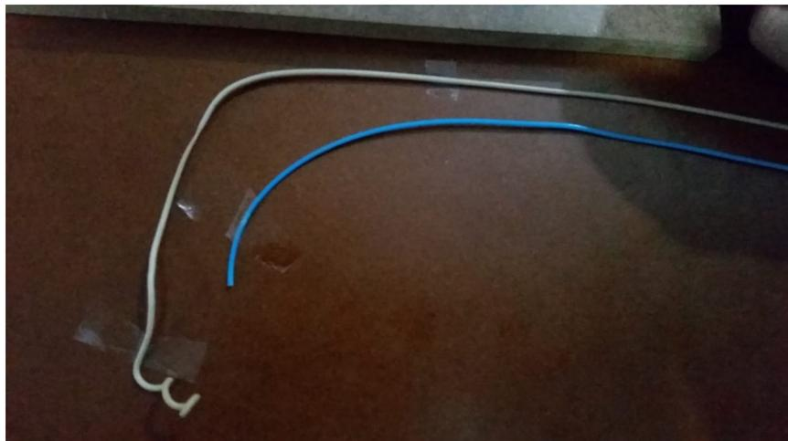
*En esta comparación entre la muestra del filamento de ABS obtenido (gris) y filamento polimérico comercial (azul) se evidencia que, a pesar de ciertas imperfecciones, el diámetro y acabado de la muestra son bastante cercanos a los de la muestra comercial*
