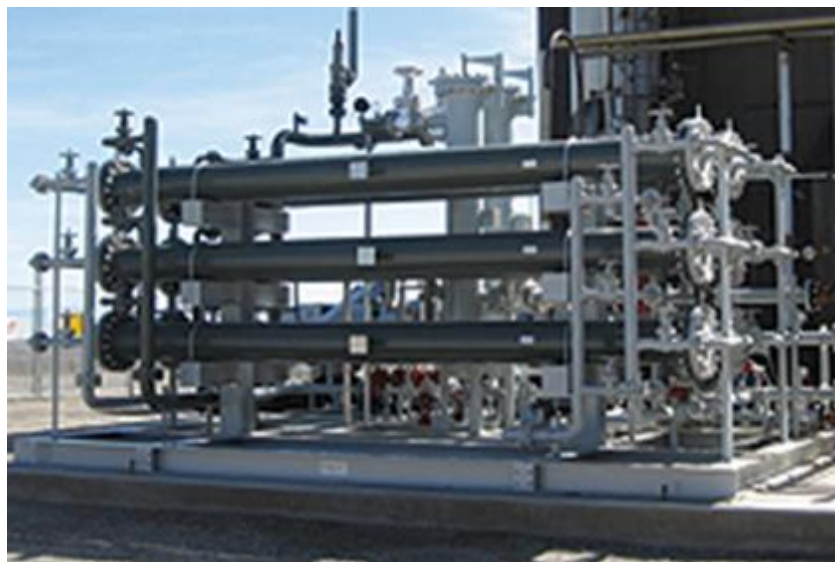
Figura 46. Ejemplo montaje de módulo de separación por membranas FuelSep™ operando en una planta de tratamiento de gas natural en Texas.
