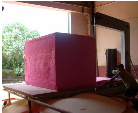
Figura 6. Proceso de refilado del bloque de espuma
