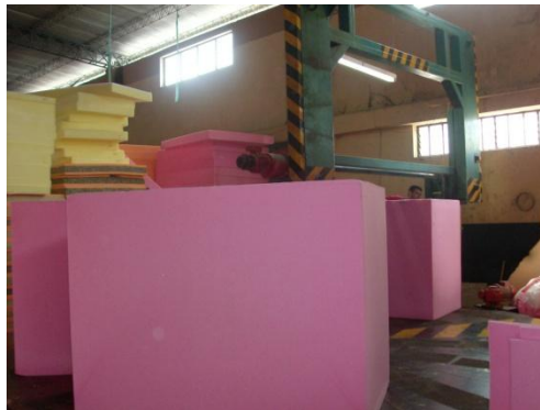
Figura 7. Corte horizontal de los bloques
