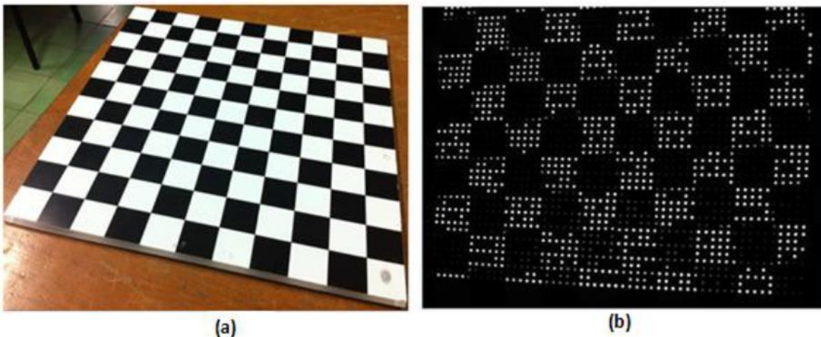
Figura 40. (a) Patrón de Calibración, (b) Proyección de puntos sobre el patrón de calibración de cuadros blancos y negros.
