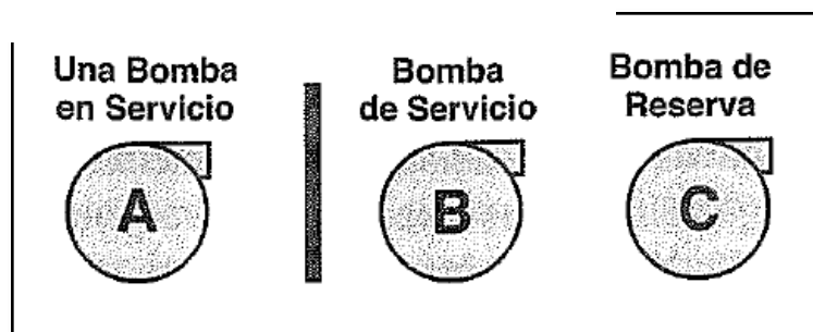
Figura 5. Sistema de bomba y su stand by
