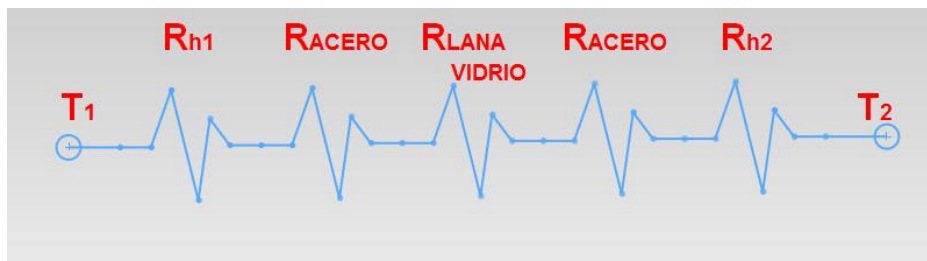
Figura 21. Red de resistencias térmicas pared cabina de incubado.
