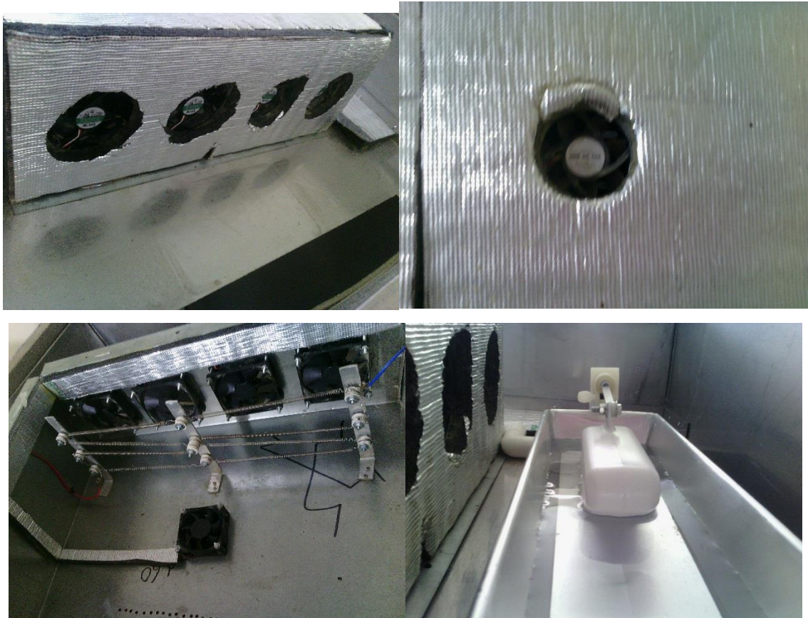
Figura 41. Unidad de calefacción y extracción de la incubadora
