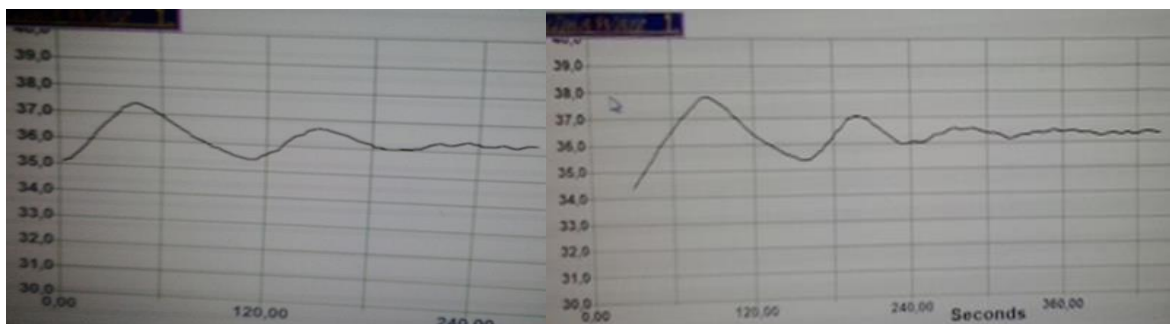
Figura 43. Respuesta control PI ( k_p=1 , k_i=1 y k_p=3 , k_i=5 )
