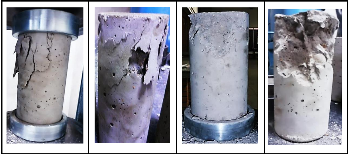
Figura 14. Formas de falla presentadas en los especímenes ensayados.
