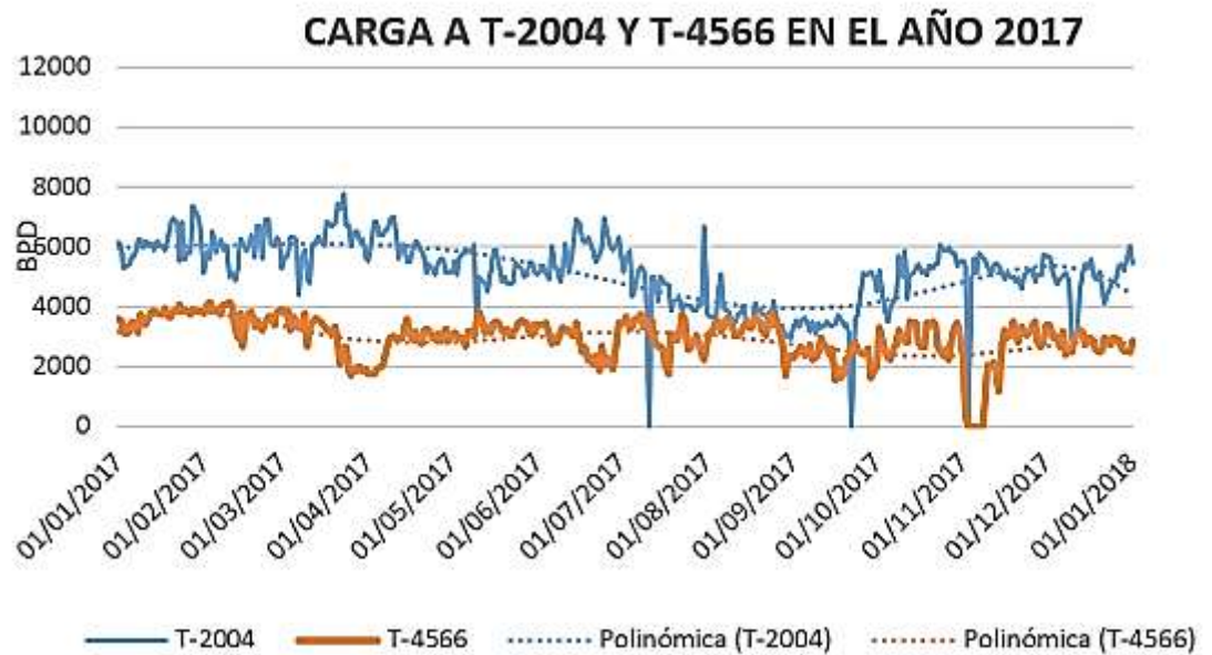
Figura C1. Datos históricos carga de GLP a la torre de destilación T-4566 Y T-2004 en el año 2017.
