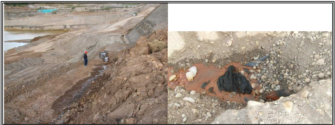
Fotografía 11. Afloramiento de aguas internas en la masa deslizada.
