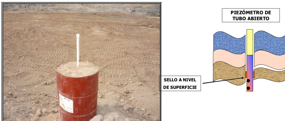
Fotografía 26. Piezómetro de Casagrande o tubo abierto.
