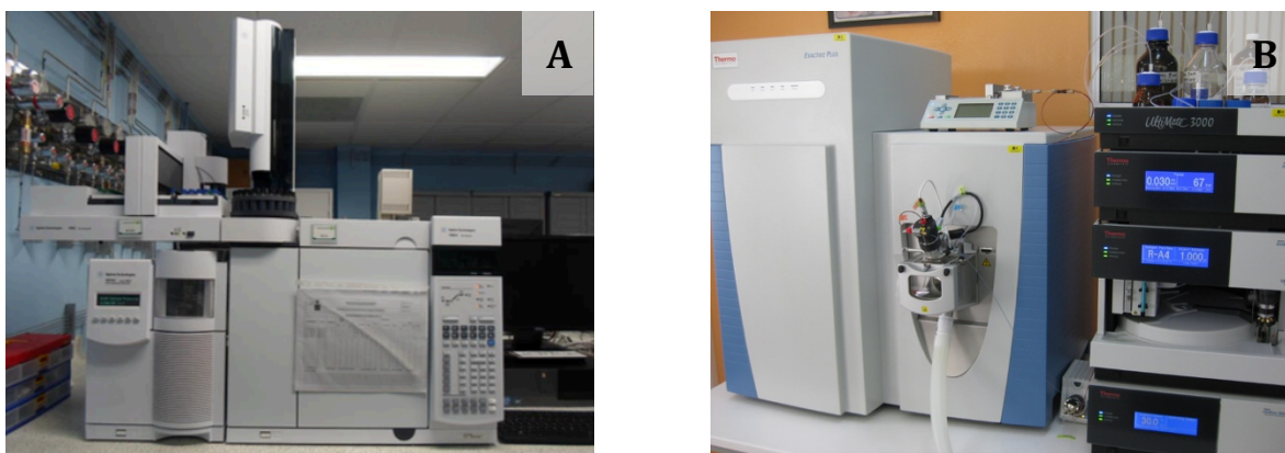
Figura 11. A. Cromatógrafo de gases AT 6890 Plus acoplado a un detector selectivo de masas AT 5973 Network .; B. Cromatógrafo líquido (UHPLC, Dionex Ultimate 3000 ), acoplado a un espectrómetro de masas Orbitrap (Exactive Plus, Thermo Scientific) . Fuente: Yesica Bautista Correa. Lugar: Laboratorio de Instrumentación Analítica CROM-MASS, UIS. Bucaramanga. Fecha: 17 de noviembre de 2017.
