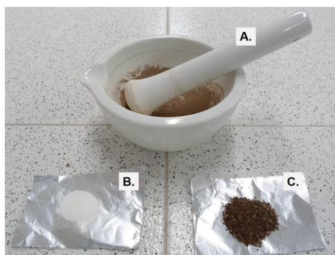
Figura 8. Proceso de obtención de extractos por dispersión de la matriz en fase sólida. A. Mortero con pistilo, B. Agente dispersante (soporte sólido), C. Material vegetal. Fuente: Samir Suárez. Lugar: CENIVAM. UIS, Bucaramanga. Fecha: 10 de noviembre de 2016.
