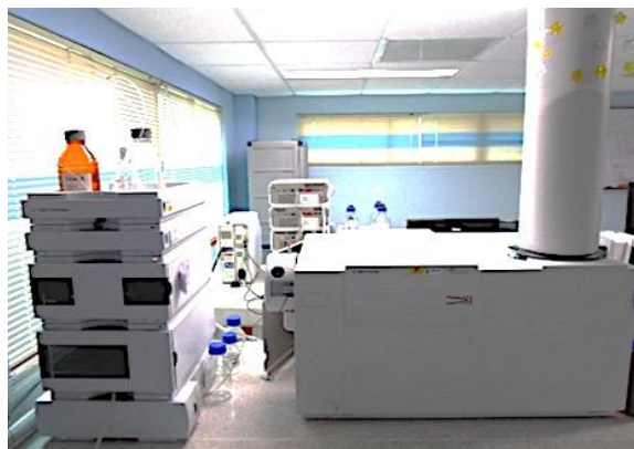
Figura 9. Cromatógrafo líquido AT 1200 Series con analizador de tiempo de vuelo AT TOF-MS 6210 Series. Fuente: Yesica Bautista Correa. Lugar: Laboratorio de Instrumentación Analítica CROM-MASS, UIS. Bucaramanga. Fecha: 17 de noviembre de 2017.
