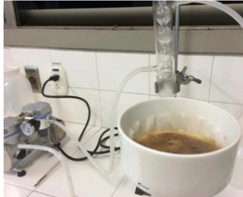
Figura B1. Montaje de la separación sólido líquido por filtración
