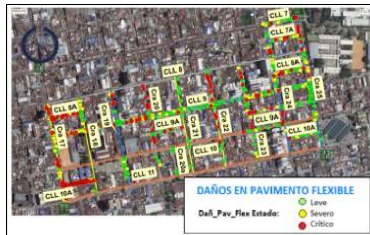
Figura 12. Ubicación de daños en pavimento flexible.
