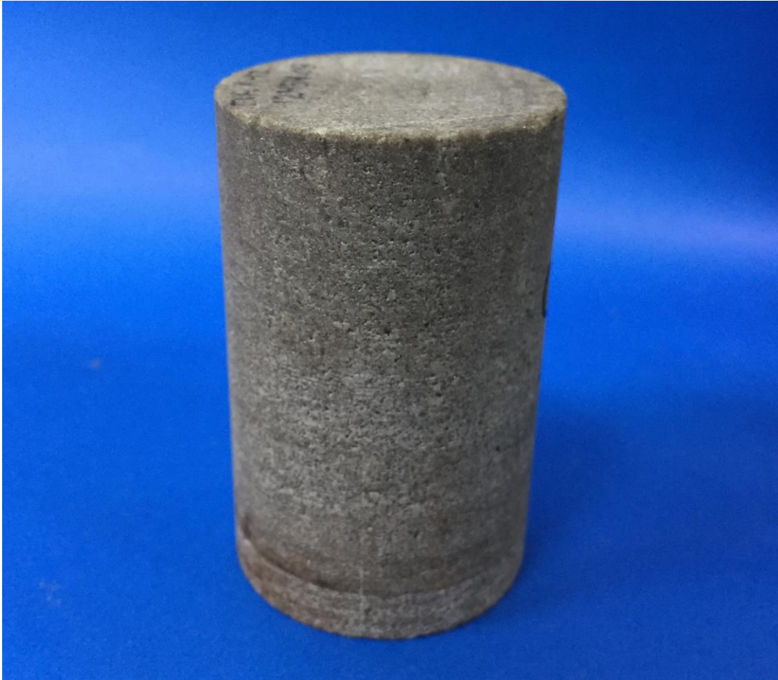
Figura 10. Muestra plug de campo Cupiagua
