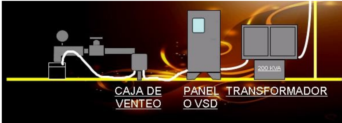
FIGURA . Equipo de superficie del Bombeo Electrosurgible
