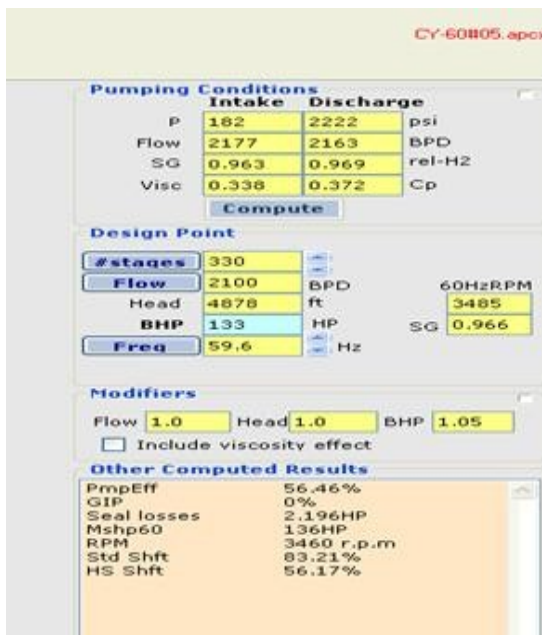
FIGURA . Condiciones de la Bomba de Subsuelo para el pozo 1.
