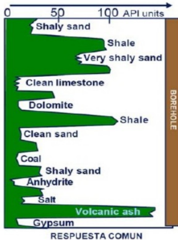
FIGURA . Interpretación general de los registros Gamma Ray.
