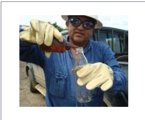
FIGURA . Aplicación de rompedor para muestreo de BSW.
