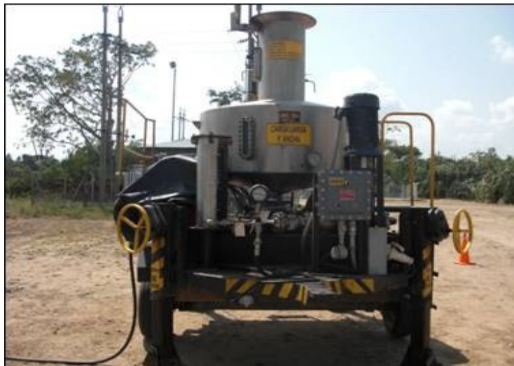
FIGURA . Equipo completo de medición de BSW por prueba de Tanque Seraphin.
