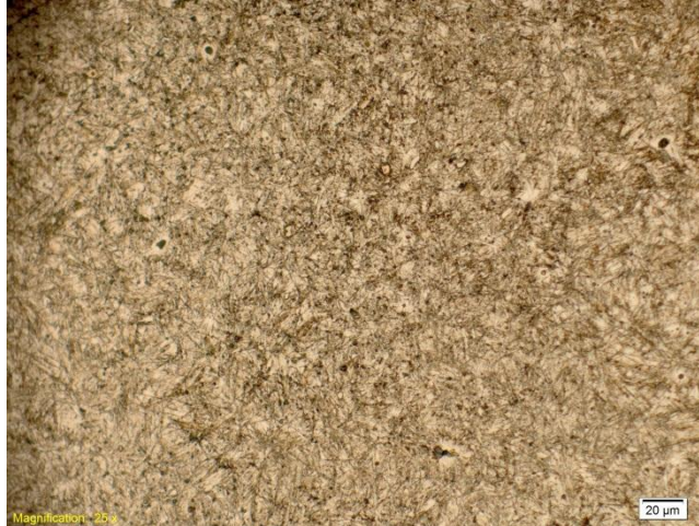
Figura 40. Sustrato atacado aumentado 25x
