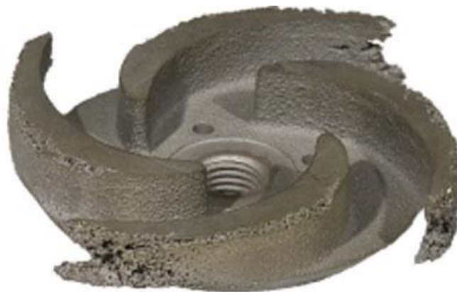
Figura 22. Desgaste por Cavitación
