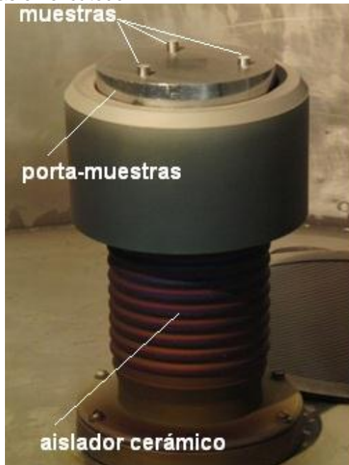
Figura 5. Montaje de probetas en el cátodo
