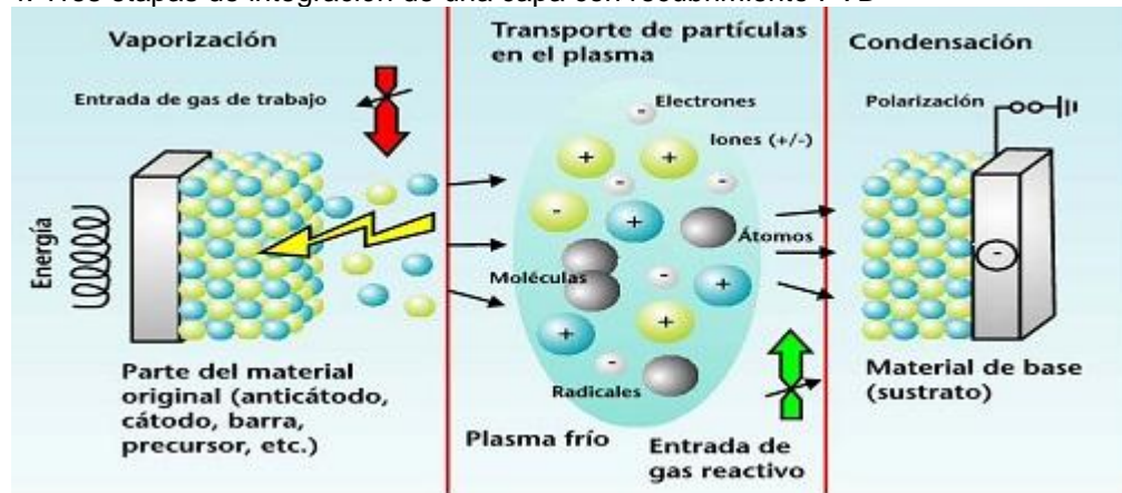
Figura 4. Tres etapas de integración de una capa con recubrimiento PVD
