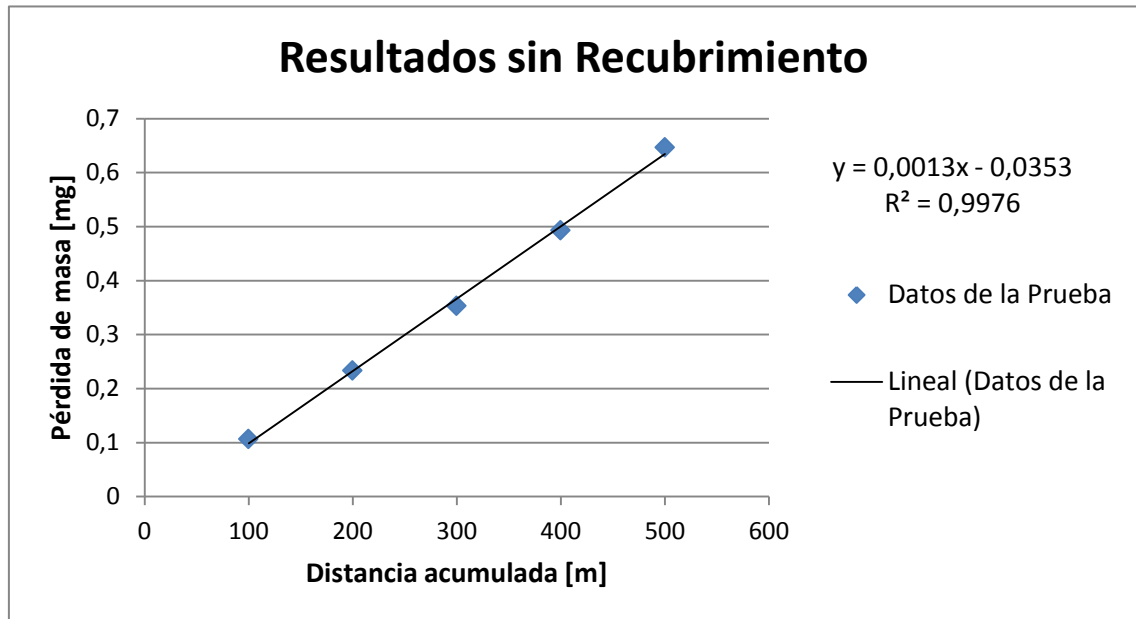
Figura 69. Desgaste másico en función de la distancia deslizada para las muestras sin recubrimiento
