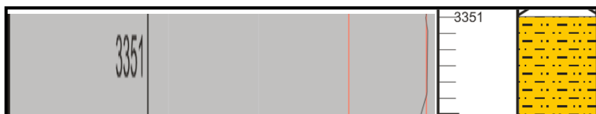
Figura 29. El registro SP indica un sedimento fino como shale y en la descripción sedimentológica se identifico una limolita arenosa a una profundidad de 1021.38 a 1021.6 metros (3351 a 3351.7 pies).
