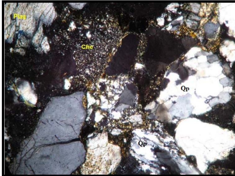
Figura 18. Fotografía con objetivo de 10X con nicols cruzados. Vemos cuarzo policristalino (Qp) con contactos suturados, un cuarzo policristalino con cristales orientados en la parte interior, chert (Che) y plagioclasa (Plag).
