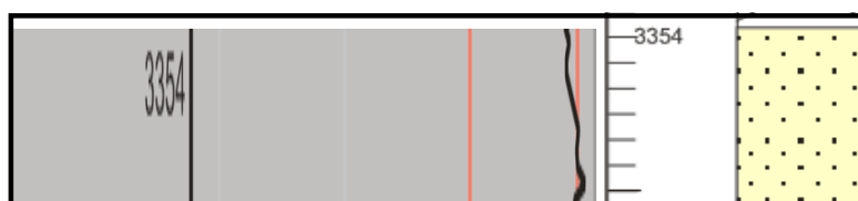
Figura 30. El registro SP indica un sedimento fino como shale pero en la descripción sedimentológica se identifico una subarcosa de grano fino a una profundidad de 1022.3 a 1022.5 metros (3354 a 3354.7 pies).
