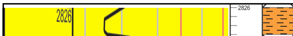
Figura 35. El registro SP indica arenas pero en el núcleo se describió una arcillolita a una profundidad de 861.36 a 862.28 metros (2826 a 2829 pies).
