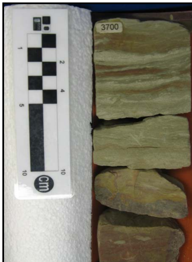
Figura 13. Limolita varicoloreada 5R3/4, 10R2/2, 5R4/2 y 5YR5/6 con desarrollo de paleosuelo, al tope se presenta una subarcosa bien seleccionada.
