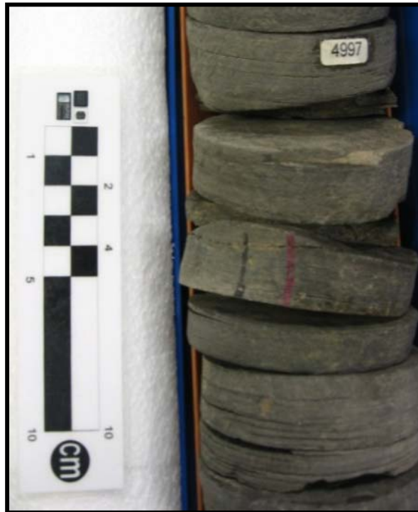
Figura 12. Shale fisil de color N1 a N2, con laminación plano paralela, calcáreo a ligeramente calcáreo, con presencia de pequeños nódulos de azufre.
