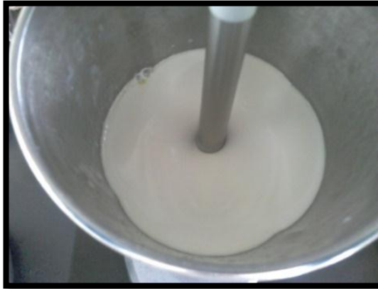
Figura 15. Preparación del Fluido Drill-in Base Aceite Emulsionado.
