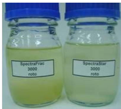
Figura 3. Izquierda. Comparación de la apariencia del fluido preparado con GW-27 (izquierda) y con GW-3 (derecha). Derecha. Foto superior del residuo y precipitado flotante que deja el polímero GW-27, después de someter el fluido de fractura a rompimiento.
