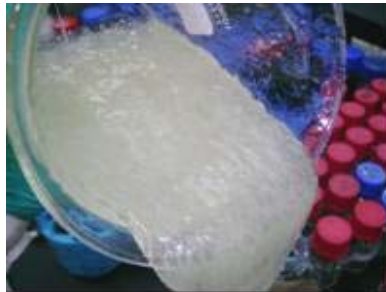
Figura 12. Fluido de fractura o gel ROTO después de agregarle rompedor puro y someterlo a temperatura en el laboratorio.
