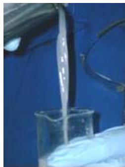
Figura 12. Fluido de fractura o gel ROTO después de agregarle rompedor puro y someterlo a temperatura en el laboratorio.
