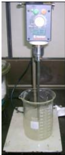
Figura G1. Agitador mecánico de aspas planas utilizado para la preparación de fluidos de fractura.
