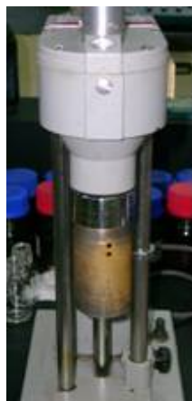
Figura G3. Viscosímetro Fann 35 utilizado para la medición de la viscosidad de los geles lineales a 300 rpm.
