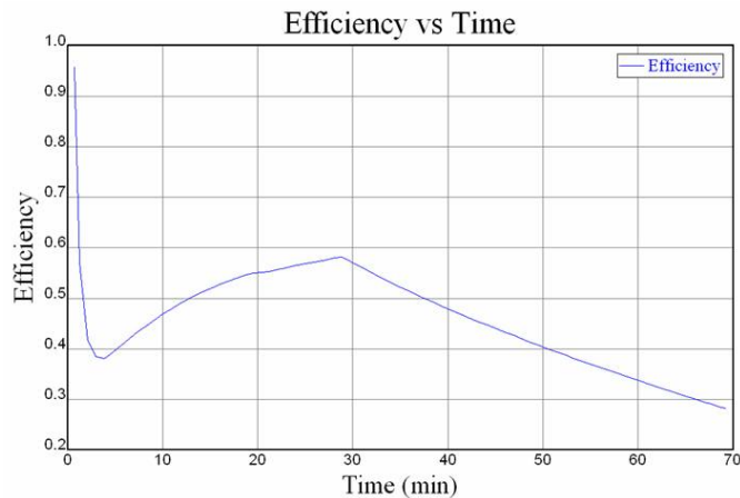
Gráfico 6. Eficiencia con respecto al tiempo del fluido de fractura base agua utilizado en el pozo YR-71, reportado por BJ Services durante el trabajo de Fracturamiento Hidráulico.
