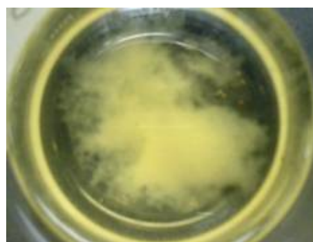
Figura 3. Izquierda. Comparación de la apariencia del fluido preparado con GW-27 (izquierda) y con GW-3 (derecha). Derecha. Foto superior del residuo y precipitado flotante que deja el polímero GW-27, después de someter el fluido de fractura a rompimiento.
