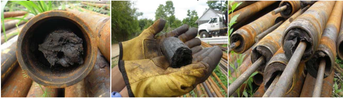
Figura 3. Parafina depositada en la tubería de producción.
