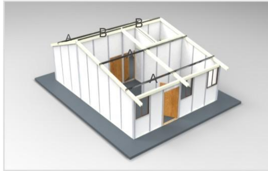
Figura74. Instalación viguetas, molduras puertas, puertas y ventanas
