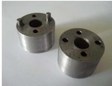
Figura 36. Molde final probeta de compresión (Acero 1020).
