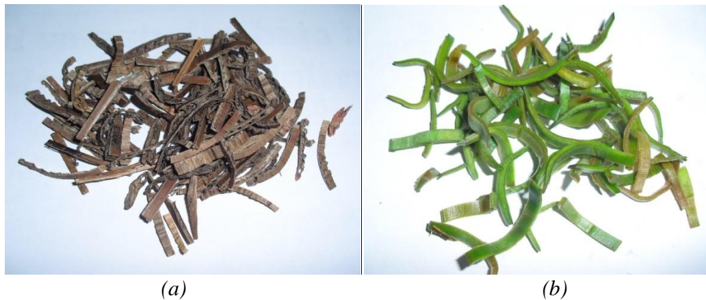
Figura 20. Material cortado en trozos. (a) calceta de plátano, (b) hoja de piña
