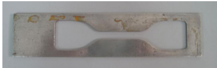
Figura 30. Molde final probeta de tracción (Acero 1020).
