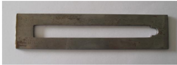
Figura 33. Molde Final probeta de flexión (Acero 1020).
