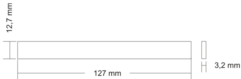
Figura 32. Medidas probetas ensayos de flexión
