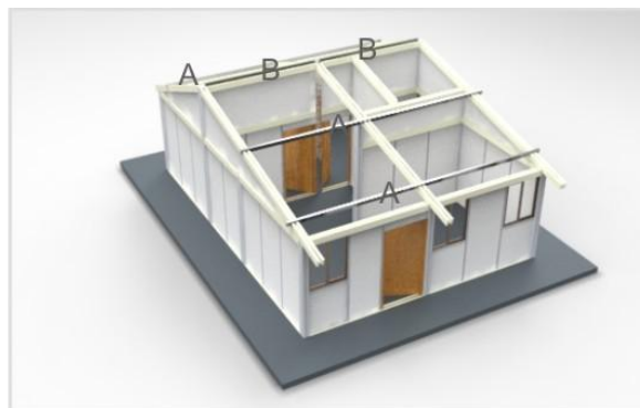
Figura 56. Instalación de viguetas, puertas y ventanas
