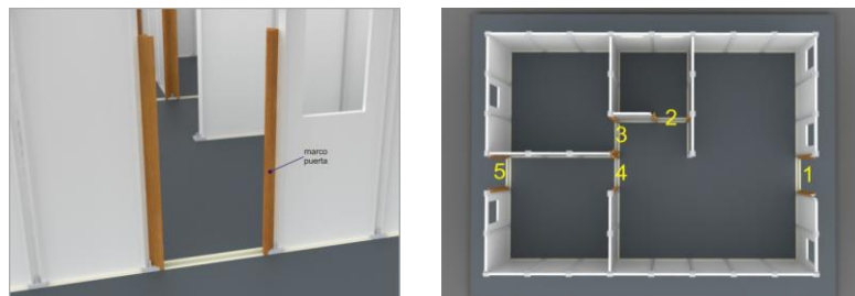
Figura 105. Instalación marcos puertas diseño final
