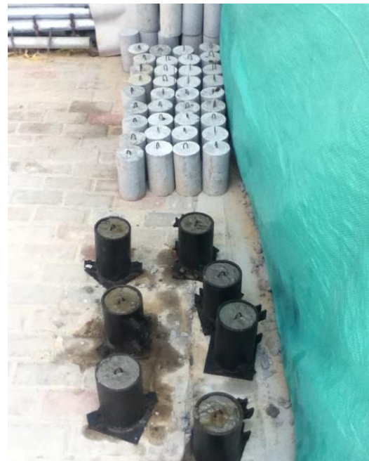
IMAGEN 4. Toma de cilindros, los cuales eran enviados a laboratorio para ser fallados.
