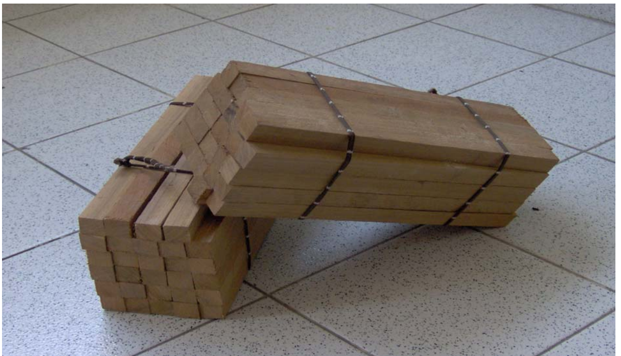
Fotografía No. 3 Probetas de Sapan para Ensayo
