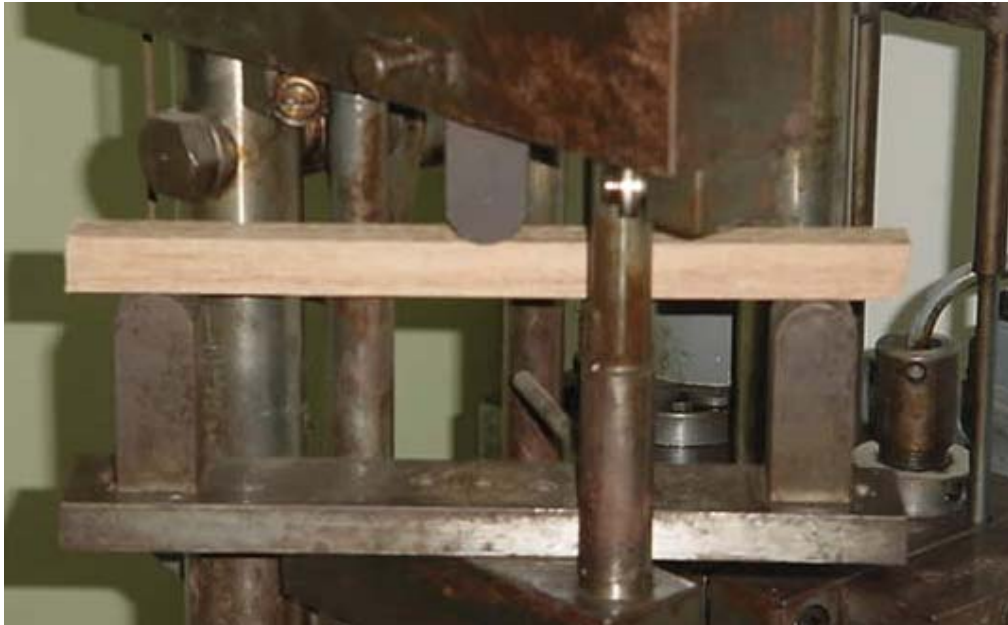
Fotografía No. 2 Ensayo a Flexión - Maquina Universal marca AMSLER
