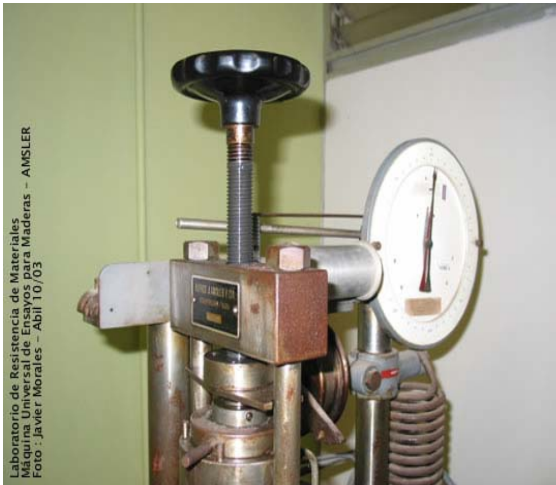
Fotografía No. 1 Máquina Universal de ensayos para Maderas - Marca AMSLER, TIPO 4 DBZF 120
