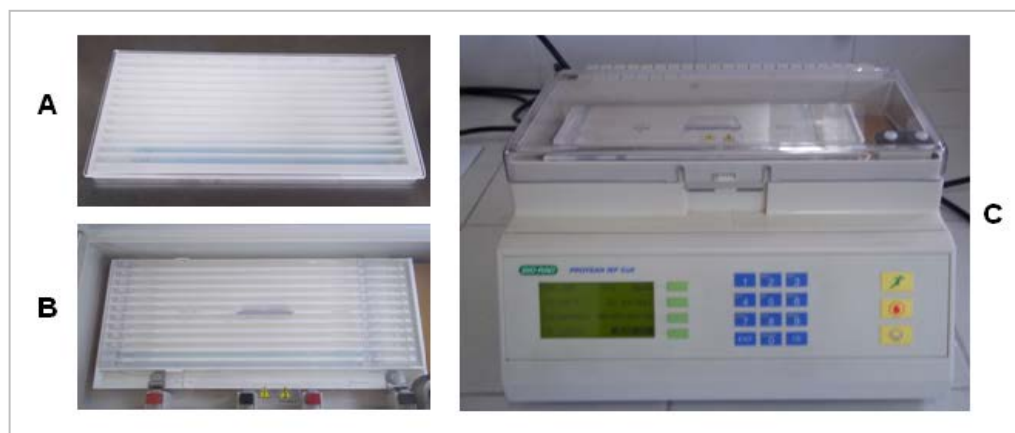
Figura 13. Separación de las proteínas de acuerdo a su punto isoeléctrico. (A) rehidratación de las tiras; (B) y (C) tiras ubicadas en la bandeja y equipo de IEF.
