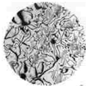
Figura 5. Microestructura del hierro gris ( ferrita y perlita)
