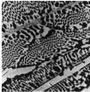
Figura 6. Microestructura de la fundición blanca
