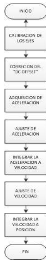
Figura 15. Esquema general de metodología de cálculo de condiciones dinámicas.
