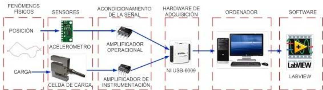
Figura 47. Estructura del sistema de adquisición de datos basado en National Instruments.
