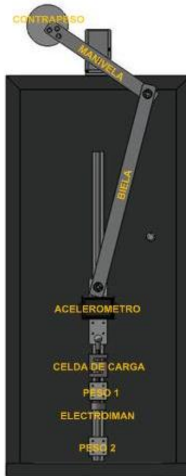
Figura 11. Elementos del mecanismo del PEULA.
