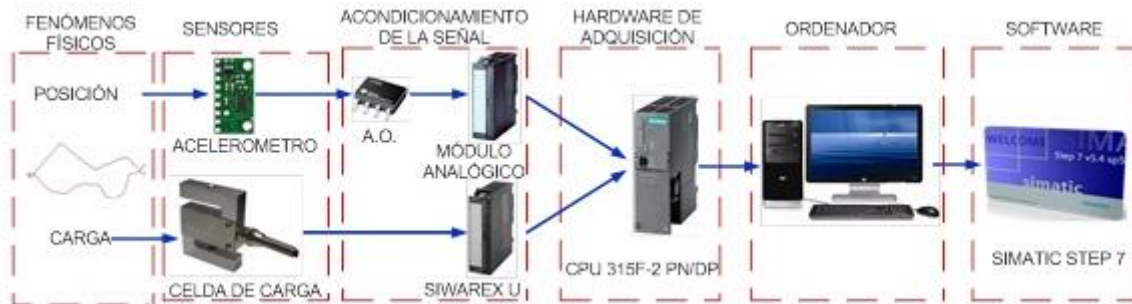
Figura 48. Estructura del sistema de adquisición de datos basado en PLC.
