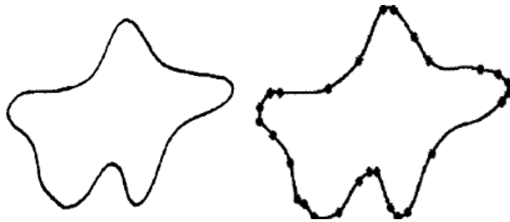
Figura 39. Curva original y curva con únicamente puntos significativos.
