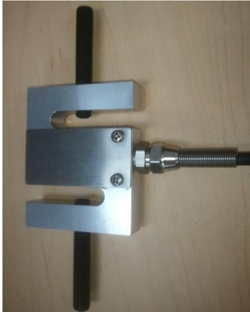
Figura 54. Celda de carga instalada en el mecanismo.
