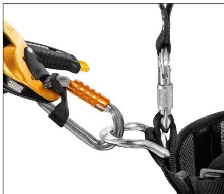
El mosquetón Am'D tiene una forma en D, asimétrica, idónea para la conexión de los aparatos del tipo descensores o elementos de amarre de sujeción. La utilización de la barra CAPTIV favorece la sollicitación del mosquetón según el eje mayor, limita el riesgo de volteo y lo solidariza con el aparato o con el elemento de amarre.
