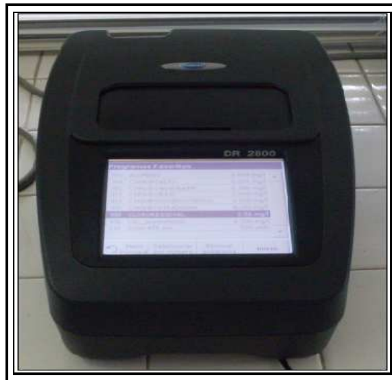
Figura 25. Espectrofotómetro HACH DR- 2000/DR-2400/ DR-2800
