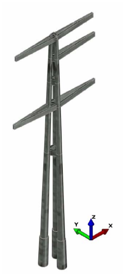
Figura 5.1. Estructura en concreto tipo triangular con doble cable de guarda y crucetas en concreto
