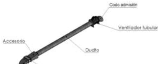
La distribución del ducto, ventilador y batería se representa en la Figura 38. Considerando que se ha seleccionado un ventilador tipo tubular, el cual estará ubicado cerca de la entrada de aire, se procederá a diseñar el ducto de admisión. El ducto estará compuesto principalmente por un codo
