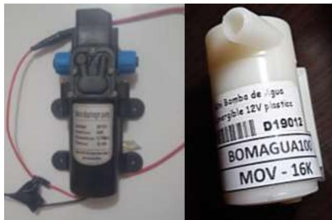
La altura hasta nebulizadores es,  $\Delta H_h = 0.8m$  metros, una presión de salida manométrica de la bomba de diafragma disponible es de  $P_d = 0.75Mpa = 76.5m. c. a.$ . El caudal solicitado por los dos nebulizadores es de  $Q=0.15LPM$ , dato relevante para calcular las perdidas energéticas del de flujo de agua a temperatura ambiente modelado como incompresible, estacionario y
