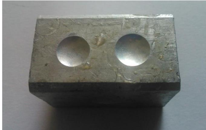
Para darle la curvatura a los domos para que se puedan acomodar correctamente a las compuertas. Se deja secar por 8 minutos la resina en el molde y al estar húmeda se ubica en las compuertas y se pega con cinta, al dejarse secar la resina se endurece adquiriendo la curvatura requerida con un diámetro de 1 cm.
