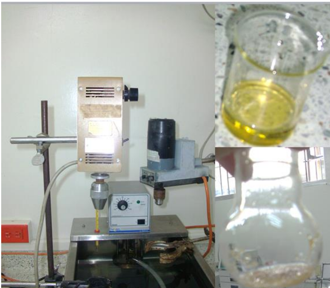
Figura 4. Montaje utilizado para llevar a cabo la reacción de alcoholisis (izquierda), aceite de Jatropha curcas (derecho superior), balón 1440 con enzima TL IM después de un lavado (derecha inferior).
