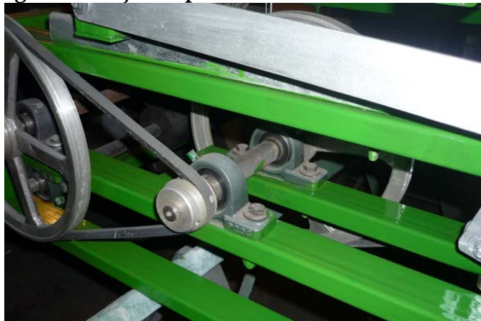
Figura 118. Eje simple de reducción de velocidad.
