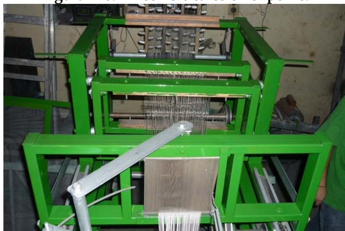
Figura 110. Hilos verticales en el peine.
