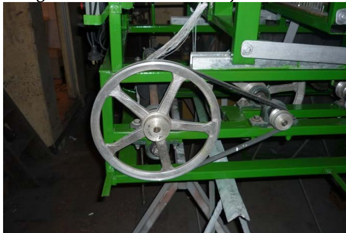
Figura 117. Polea 1 sobre el eje del rodillo.
