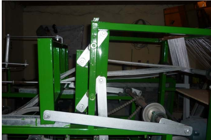
Figura 111. Manivela-biela-corredera del sistema peine
