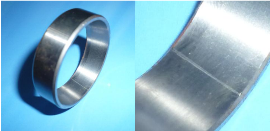
Figura 8: Falla en pista externa nivel incipiente.
