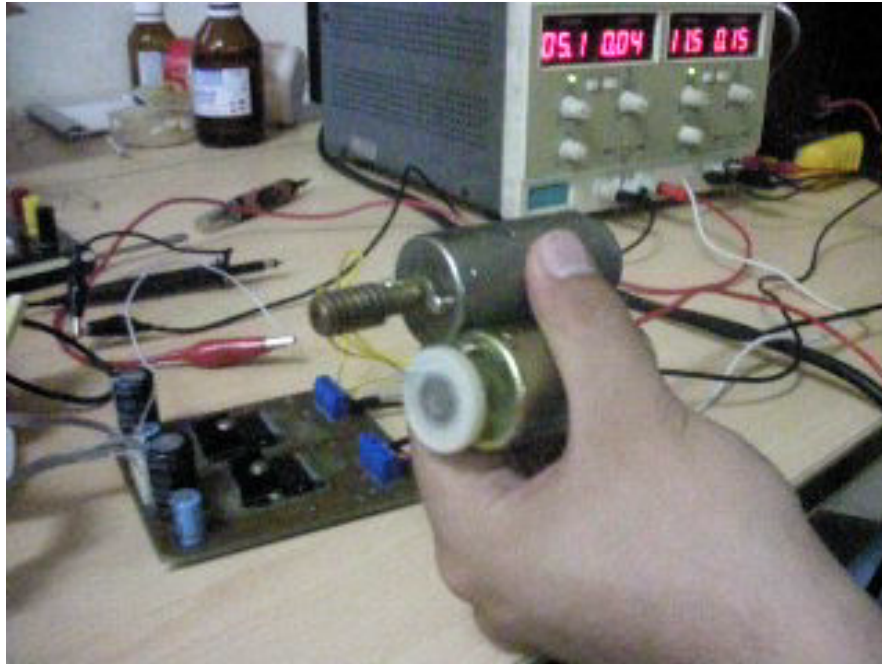
Figura 4.5: Montaje para Prueba Física de PWM con etapa de Potencia
