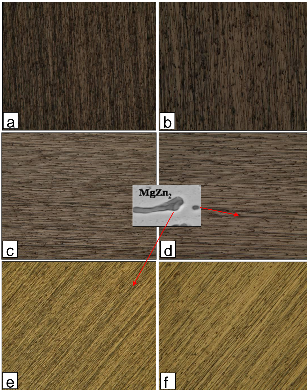
Fotografía 7. Probetas después de inmersión en las mezclas a) E5 T 5 100x, b) E5 T 5 200x, c) E10 T 5 100x, d) E10 T 5 200x, e) E15 T 5 100x, f) E5 T 5 200x.
