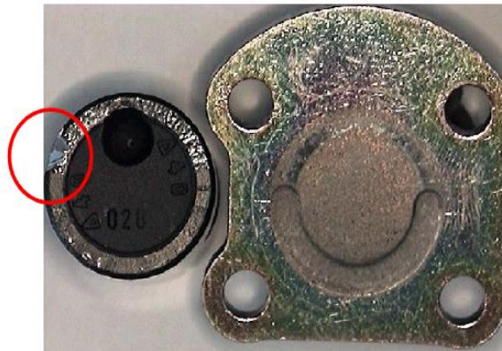
Figura 4. Daño en el pistón de aluminio debido a taponamiento del filtro
