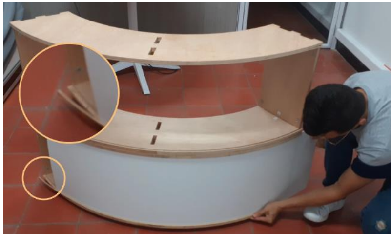
Figura 63. Deterioro del riel
