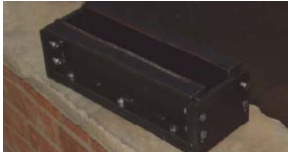
Figura 2-10: Molde para la Realización de Vigas
