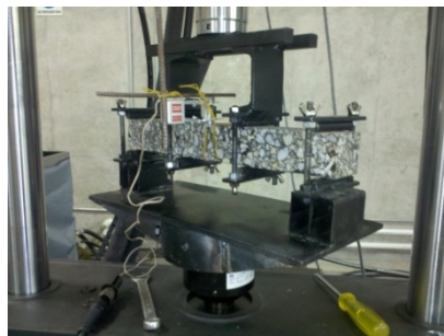
Figura 3-4: Ensayo de Flexión en 4 Puntos (Módulo Complejo)
