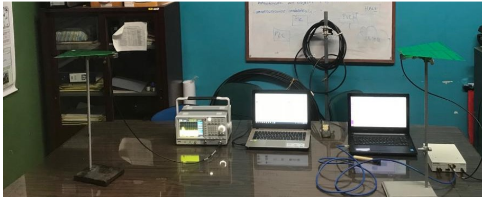
Figura 9: Montaje utilizado para las pruebas de transmisión y recepción
