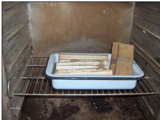
Fotografía 10. Secado de Latas de Guadua en Estufa.
