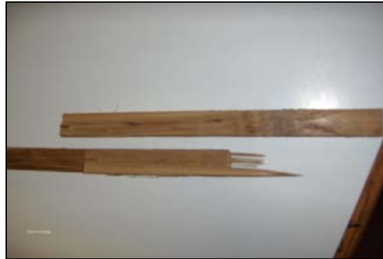
Fotografía 13. Probeta Fallada por Tracción.
