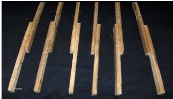
Fotografía 3. Probetas para Tracción para Adhesivo.
