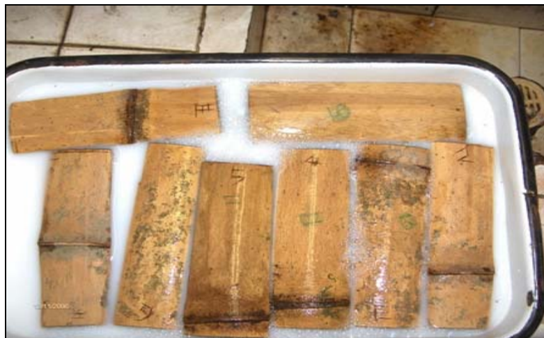
Fotografía 11. Inmunización de Latas de Guadua.
