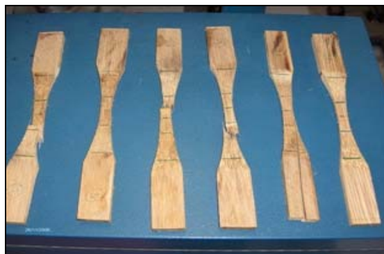
Fotografía 18. Probetas Falladas por Tracción.
