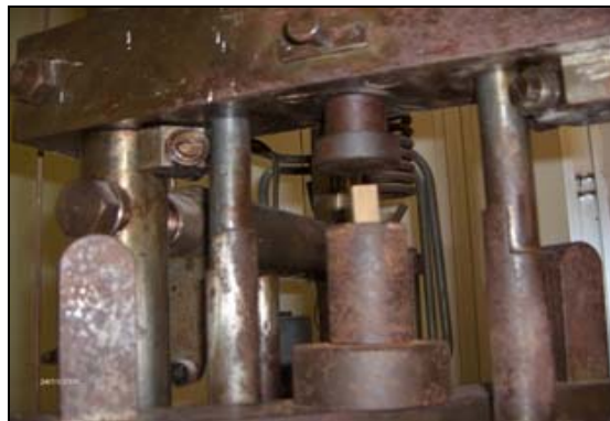
Fotografía 16. Falla por Compresión Paralela.
