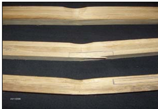
Fotografía 15. Probetas Falladas por Flexión.
