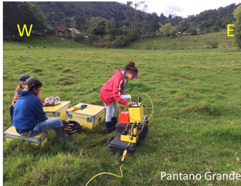
Figura 20. TRE. Transecta de 496 m, con equipo SuperSting R8 y arreglo electrónico tipo Wenner-Schlumberger, en el sector de Pantano Grande.
