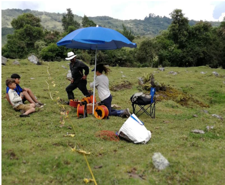
Figura 19. SEV. Transecta de 160 m, con equipo ABEM Terrameter y arreglo electrónico tipo Schlumberger, en el sector de Sabanetas.
