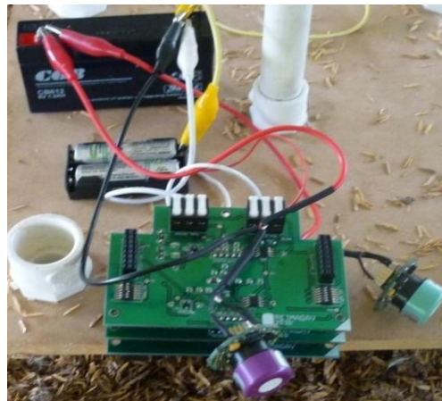
Figura 66. Nodo construido para la medición de la concentración de gases NH_3 y CO .
