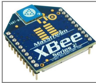
Figura 9. Representación física del dispositivo XBEE. Fuente: Hoja de datos XBEE.
