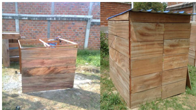
Figura 20. Marco y módulo de teja termoacústica.
