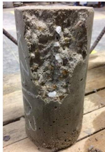
Figura E- 3. Cilindro con adición de %PET triturado, retenido en el tamiz #8
