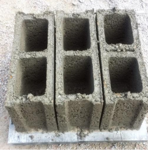
Figura 9. Bloques H-15convencionales realizados con la ayuda de Dipreco S.A.
