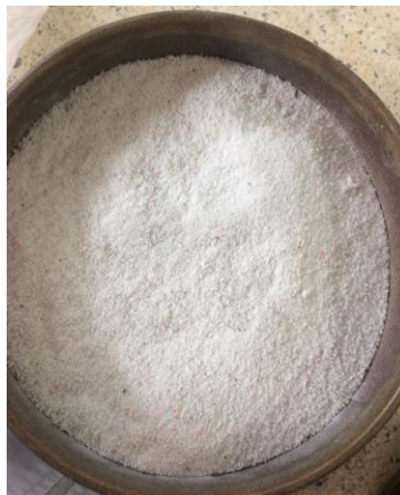
Figura 5. Polietileno Tereftalato (PET), pulverizado tamiz N°50
