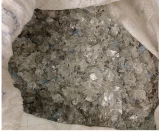
Figura E- 1. Polietileno Tereftalato (PET), triturado tamiz #8.
