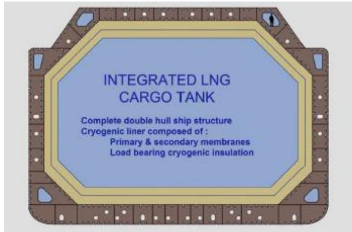
Figura 35. Esquema tanque tipo membrana
