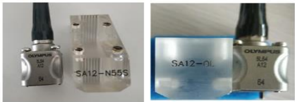
Figura 44. Zapata sectorial (derecho) y zapata lineal (izquierdo)
