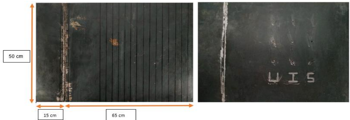
Figura 53. Dimensiones placa de acero SAE 1020
