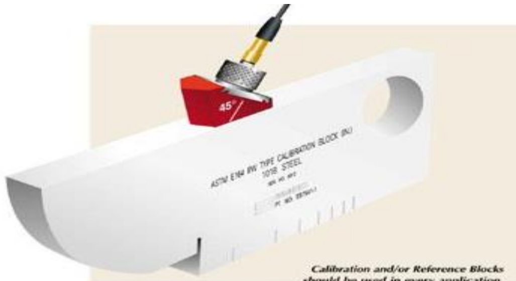
Figura 35. Bloque IIW V1
