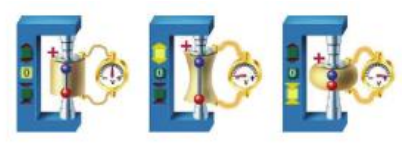
Figura 9. Efecto Piezo eléctrico
