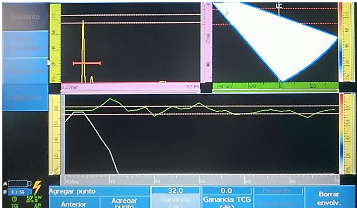
Figura 48. Calibración curva TCG.
