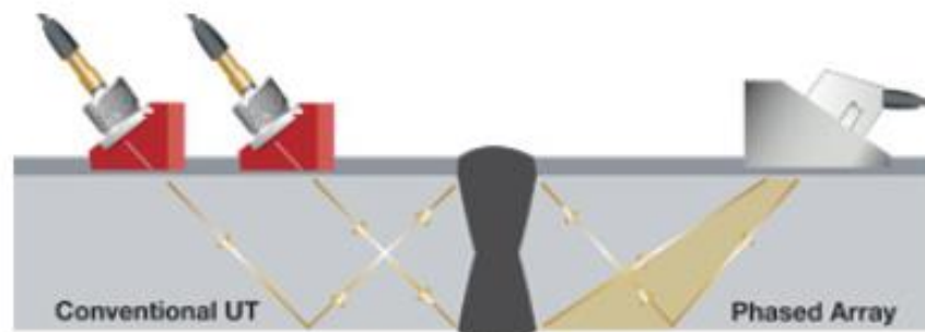
Figura 11. Ultrasonido convencional vs Ultrasonido Phased Array
