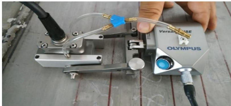
Figura 50. Ensamble VersaMOUSE-zapata lineal
