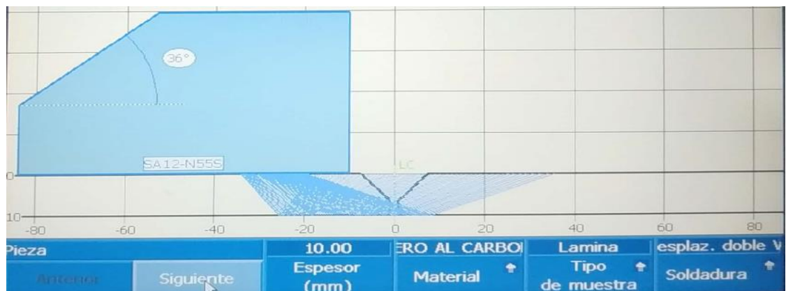
Figura 62. Configuración final para inspección de soldadura sobre placa de acero SAE 1020
